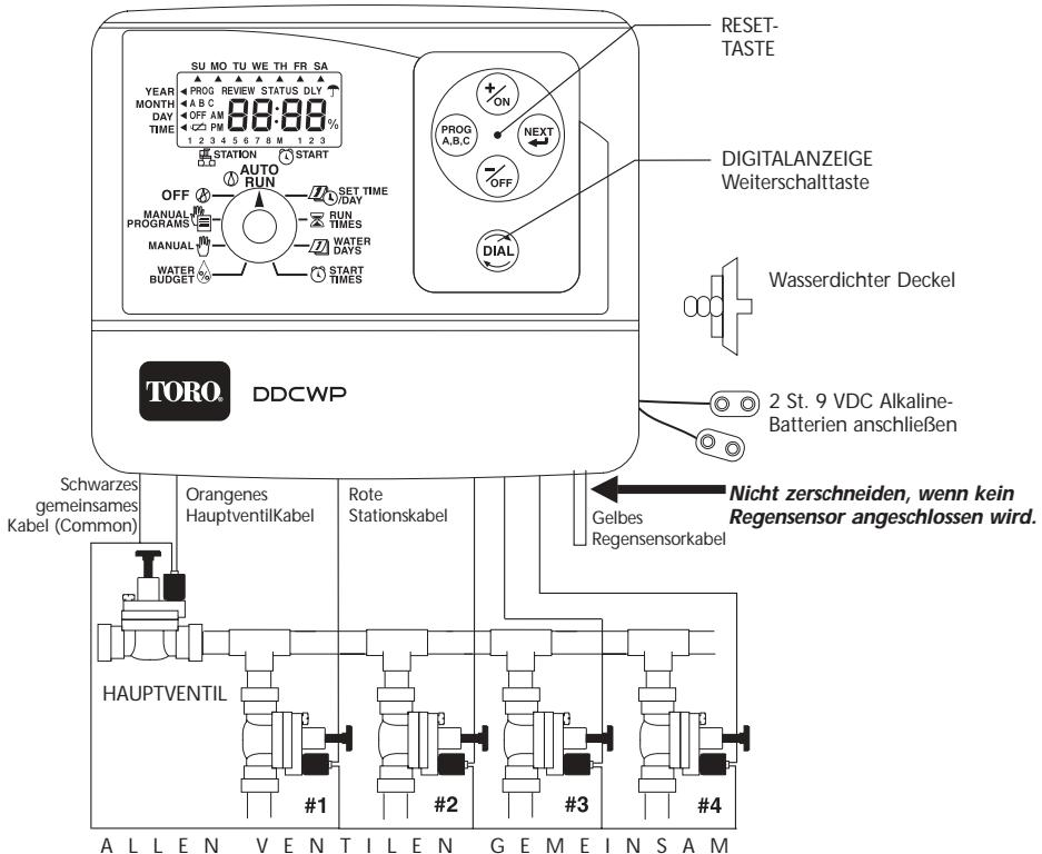
Nachdem die Stationskabel angeschlossen sind, den wasserdichten Batteriefachdeckel durch Drehen gegen den Uhrzeigersinn öffnen und die zwei Batterieanschlüsse herausholen.
