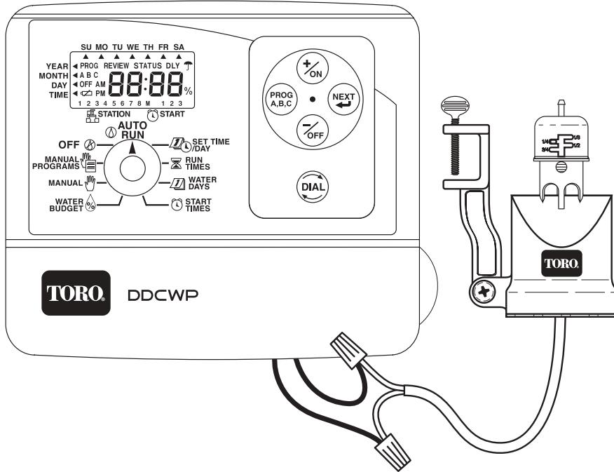
An das DDCWP kann ein Toro TRS Rain Sensor™ Regensor mit Kabelübertragung angeschlossen werden. Hierzu das gelbe Kabel des Steuergerätes durchtrennen und die beiden Kabel des Regensors mittels wasserdichter Verbinder an die beiden gelben Kabelenden des Steuergerätes anschließen.
