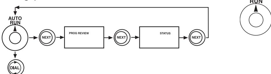
Die Position AUTO-RUN (AUTOMATIK) liefert Informationen zum Betrieb der Steuerung und gestattet die Prüfung aller in den Bewässerungsprogrammen gespeicherten Daten.
